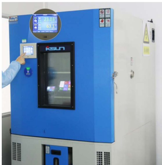
图 6-3 高低温老化测试图
